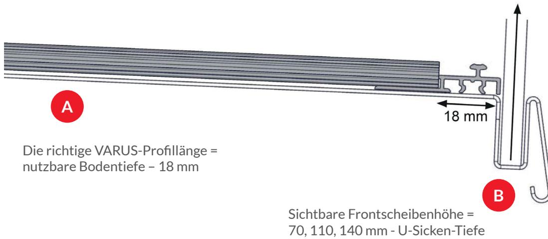
● **POS-T VARUS mit Adapter-T Profil L005
