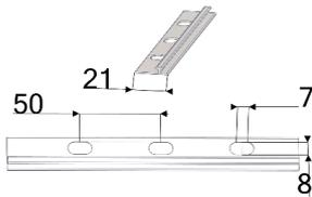
Adapter-T Profile zur Befestigung von Systemelementen, z. B. Fachteilern und Warenvorschüben, auf **Drahtböden**.
