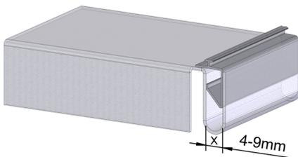
Adapter-T Profile zur Befestigung von Systemelementen, zum Einstecken in die U-Sicke von Systemböden.
