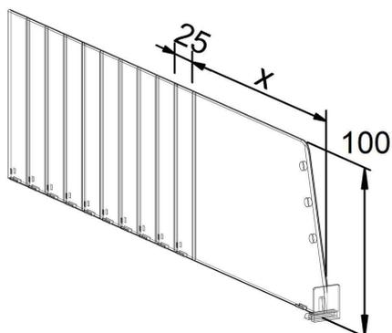
Frontanschlag B20 x H17,5 mm. Zur Trennung von Produkten bis zu einer Höhe von max. 200 mm.
