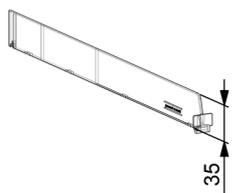
Frontanschlag B20 x H17,5 mm. Zur Trennung von Produkten bis zu einer Höhe von max. 60 mm.
