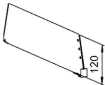
Frontanschlag B20 x H25 mm. Zur Trennung von Produkten bis zu einer Höhe von max. 240 mm.
