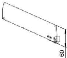
Frontanschlag B20 x H25 mm. Zur Trennung von Produkten bis zu einer Höhe von max. 120 mm.
