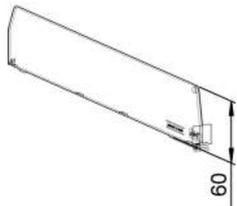
Butée frontale L20 x H25 mm. Pour séparer les produits d'une hauteur maximum de 120 mm.
