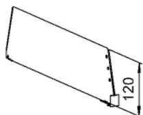
Butée frontale L20 x H25 mm. Pour séparer les produits d'une hauteur maximum de 240 mm.
