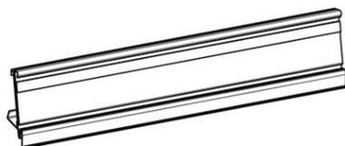
Les rails ESL13 ne peuvent être utilisés qu'avec le rail en T A056. Adapté à l'étiquette SoluM de la série Newton et Hanshow de la série Nebular. Pour tablettes avec bords en U de **Linovag, Harres, Storebest, Tegometall, Linde et Carrier**. ESL dimension 1,6 - 11,6".
