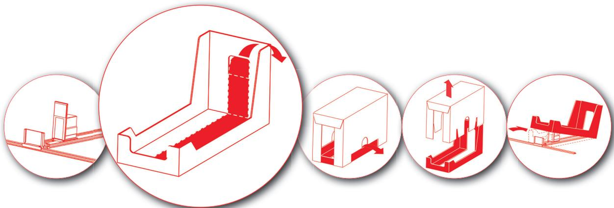
Durch eine zusätzliche Perforation an der Rück- und/oder Unterseite der Transportverpackung zur Durchführung des POS-T Warenvorschubs wird Ihr Standard-Tray zum POS-T Systemtray. Als „Einmal-Investition“ sind die Regale mit dem speziellen POS-T Vorschub für den „Tray-Betrieb“ auszurüsten.
