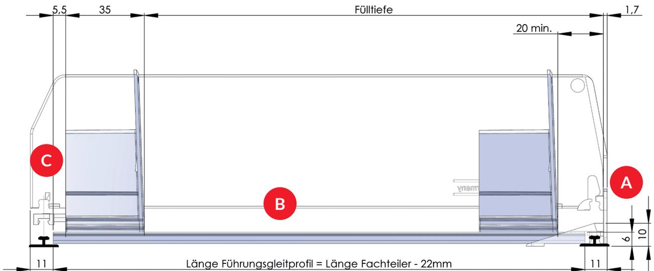
**A** Vorderer Frontanker verhindert das Herausfallen der Ware und dient als Adaptionselement des Systems. Je nach Typ sind verschiedene Frontanker-Abmessungen (Artikelzeichnungen beachten)
