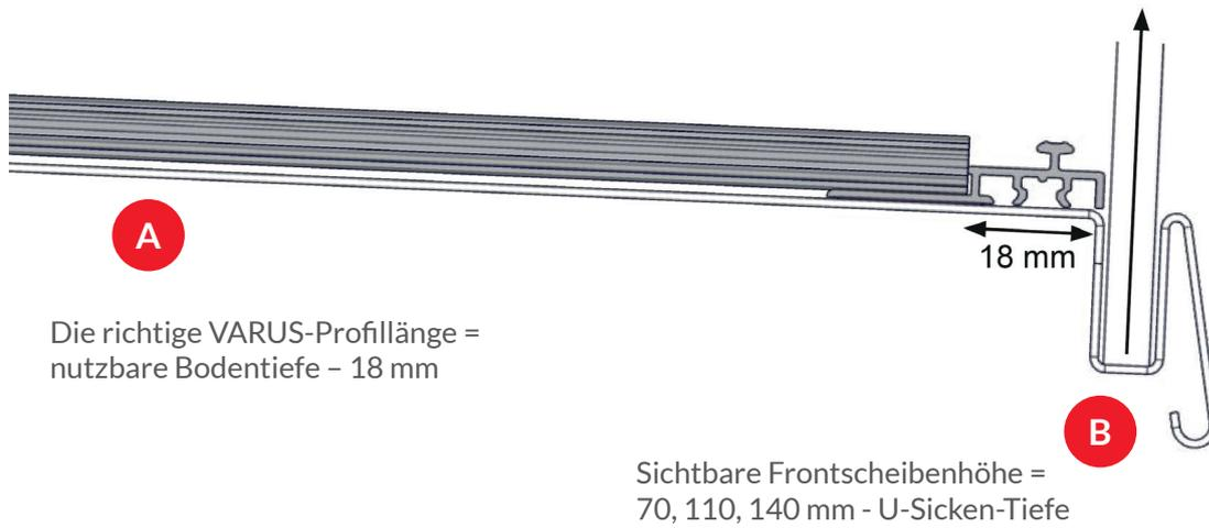
● **POS-T VARUS mit Adapter-T Profil L005
