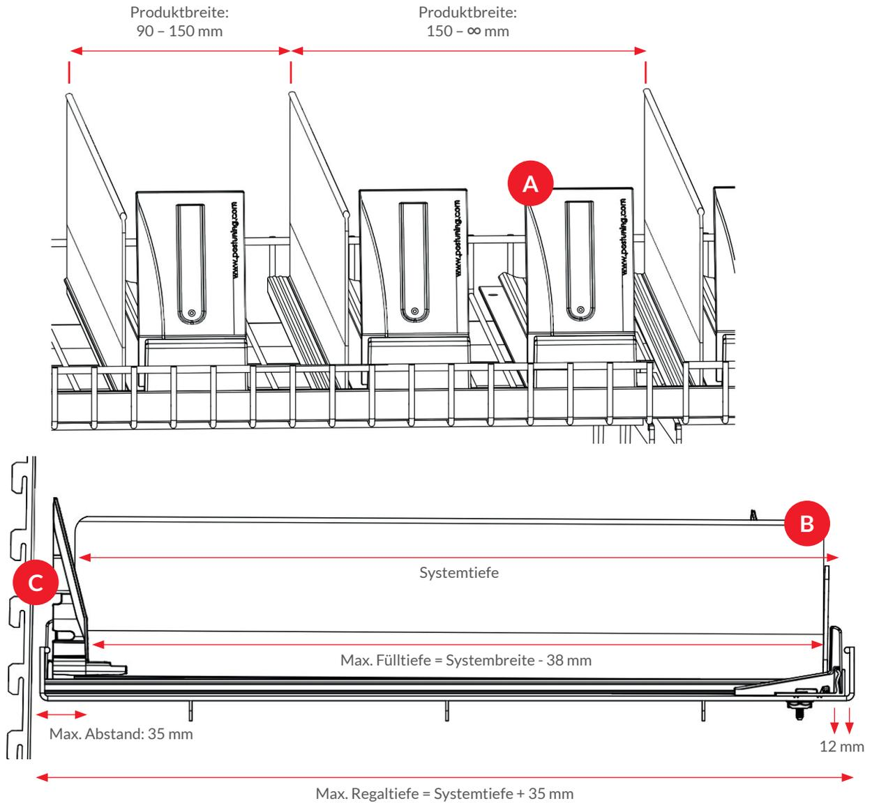
**A** Für alle Produktbreiten ab 90 mm. Ab 150 mm Produktbreite wird ein zusätzlicher Warenvorschub eingesetzt (z. B. bei Pizzen oder Beutelware).
