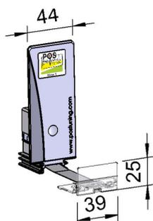
**Warenvorschub mit 25 mm Frontanschlag, mit Dämpfung, Breite 44 mm, Höhe 110 mm, lichtgrau**
